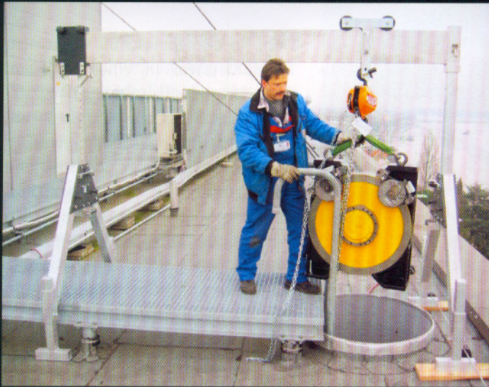
Neues Seitengestell für die Feltes-Portalkrane: Die beiden verfügbaren Varianten erlauben bei 60 bzw. 66 kg Gesamtgewicht eine maximale Traglast von 1500 kg.
